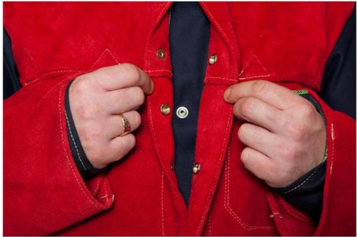
Dobbelt frontlukking, hvor alle knapper må kneppes for å hindre at gnist kommer inn.
